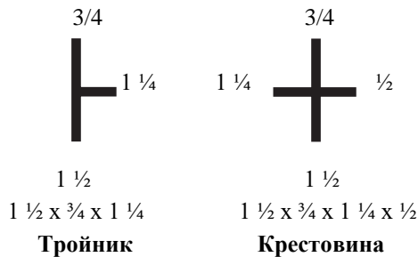
Рис.1 Способ обозначения выходов редуционных тройников и крестовин
